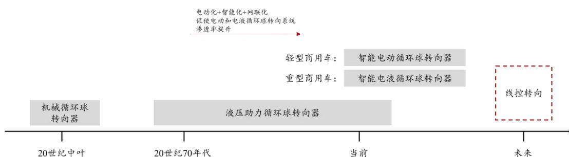
20 世纪中叶，如前所述，彼时汽车转向行业以机械式循环转向器为主流产品。20 世纪 70 年代，随着液压助力系统在中国汽车行业的普及应用，主要配套商用车的液压循环转向器的相关技术在这一时期也得到进一步的发展。
