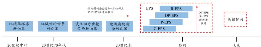
20 世纪中叶，汽车转向行业在多种类型转向器的基础上，综合发展形成了机械式循环球转向器，其以传动效率高、操作轻便、性能较为可靠等多项优势逐渐成为配套彼时多种车型的主导产品。20 世纪 70 年代，第一次石油危机促使了以大众捷达轿车为代表的省油型乘用车的出现，该类型乘用车采用前驱动方式，使得适用于乘用车的机械式齿轮齿条转向器有了用武之地。此后一段时期，随着液压助力系统在中国汽车行业的普及应用，液压助力齿轮齿条转向器逐渐成为市场主流。伴随技术进步，转向系统零部件生产厂商研制出电控技术与传统液压助力模式相结合的、操控性能更好的电控液压齿轮齿条转向器，并主要应用于高端乘用车。
